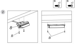
Befestigen Sie die Control Box (7) und die Tastatur (8) auf den Boden der Tischplatte.
