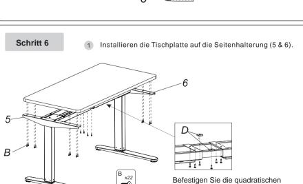
des Tragbalkens. Die Anzahl der verwendeten quadratischen Unterlegscheiben kommt auf die Länge des Stützbalkens, die auf die Grösse der Tischplatte eingestellt ist, an
